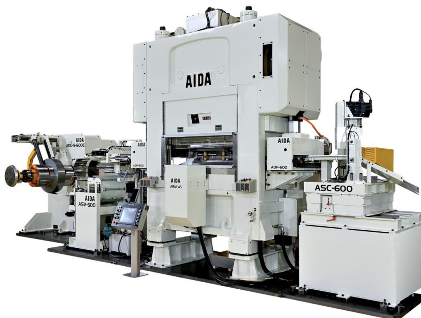
EV 駆動用モーターコア生産向け 高速精密プレスライン（プレス機械はモデル機）
